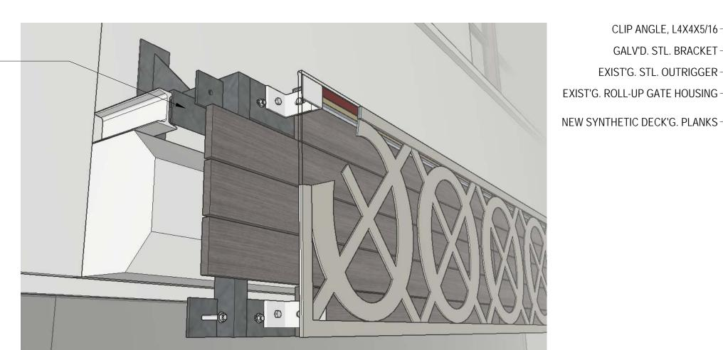
CLIP ANGLE, L4X4X5/16-GALV'D. STL. BRACKET EXIST'G. STL. OUTRIGGER EXIST'G. ROLL-UP GATE HOUSING
